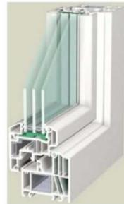
Vetri ISO con due lastre dotate di pellicola ad elevato isolamento termico. Grazie alle pellicole di tonalità neutra, Finstral offre un triplo vetro con due lastre pellicolate che garantiscono un valore di trasmissione luce del 71%. Vedasi a confronto: i vetri doppi con una pellicola raggiungono un valore di trasmissione luce del 80%. Esecuzione con spessore vetro 30 mm. Valore Ug = 0,9 W/m²K
